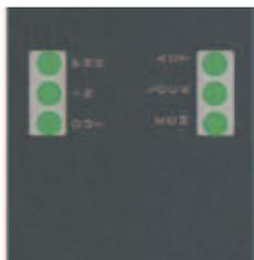
Progettati per una diagnostica rapida e immediata, lo stato di ogni ingresso e uscita viene evidenziato con un apposito LED. In questo modo si possono individuare rapidamente i punti di interruzione della catena sicura, quale dispositivo sia sbloccato, quale porta sia aperta ed eventuali errori interni al dispositivo. Il tutto in modo immediato senza la necessità di decodificare complesse sequenze di lampeggi.
